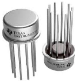
INA101AMIC OPAMP INSTR 300KHZ TO100-10 Производитель: Texas Instruments Корпус: TO-100-10 Число усилителей: 1 Скорость нарастания: 0.4 V/  $\mu$ s Граничная частота (-3db): 300kHz Входной ток смещения: 15nA Напряжение смещения: 25  $\mu$ V Потребляемый ток: 6.7mA Выходной ток (на канал): 10mA Напряжение питания:  $\pm$ 5 V ~ 20 V Рабочая температура: -25°C ~ 85°C
